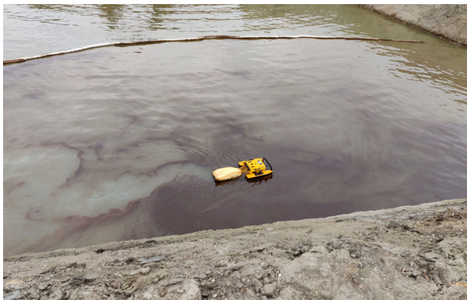
Le Jellyfishbot collectant des hydrocarbures
